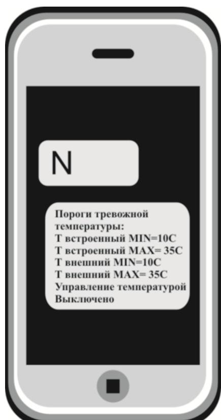
**Управление температурой отключено** – поддержание значения температуры по датчикам отключены (Если вы хотите включить управление температурой, смотрите «Управление отопительным оборудованием», стр. 12 данной инструкции).
