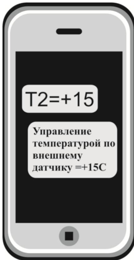
**ВНИМАНИЕ!!!** При переходе на управление температурой с помощью внешнего датчика, управление с помощью внутреннего датчика автоматически прекратится. Соответственно, наоборот: при переходе на управление температурой с помощью внутреннего датчика, управление с помощью внешнего датчика автоматически прекратится.
